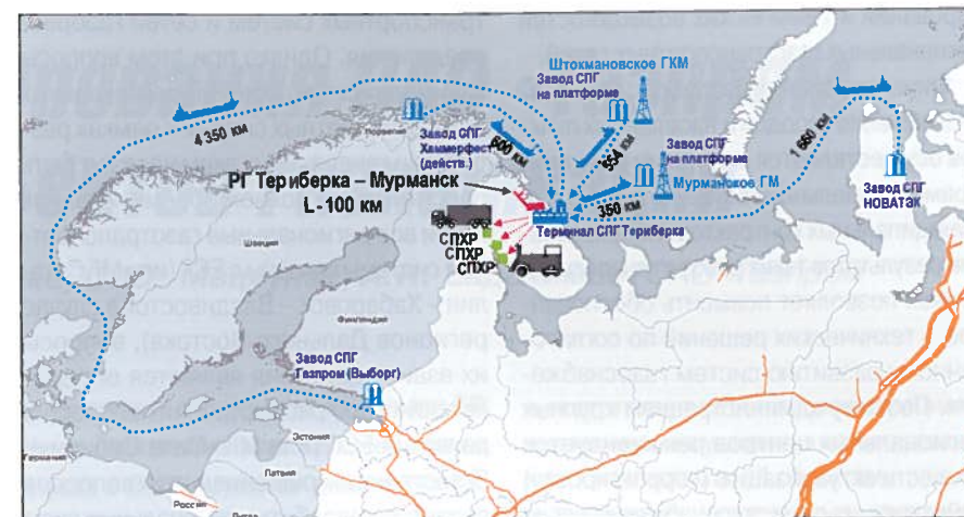
Рис. 3. Вариант газоснабжения Мурманской обл. СПГ: РГ – региональный газопровод; СПХР – станция приема, хранения и регазификации
