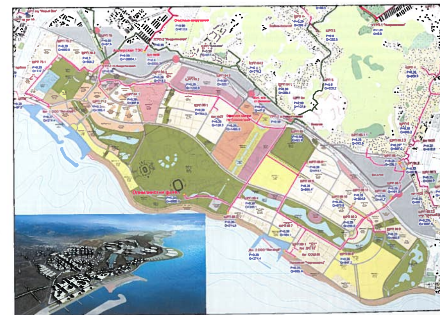
Рис. 4. Фрагмент схемы газоснабжения олимпийского кластера на Имеретинской низменности (Адлер)
